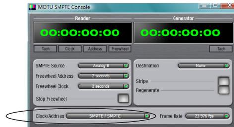
Lancez l'utilitaire MOTU SMPTE Console et spécifiez la *SMPTE Source*, qui est l'interface recevant le timecode SMPTE. Par ailleurs, vérifiez que *Clock Source/Address* est réglé sur *SMPTE/ SMPTE*.
