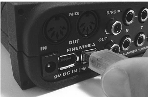
Figure 4-1 : Branchement de l'UltraLite-mk3 au port FireWire de l'ordinateur.
