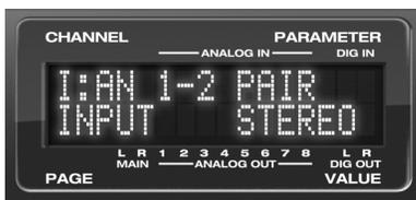
Figure 4-2 : Les paramètres à l'écran pour les entrées analogiques 1 et 2 (en tant que paire).
