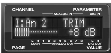
Figure 4-3 : Réglage du Trim d'entrée dans le cas d'une paire d'entrées analogiques sur jack TRS.
