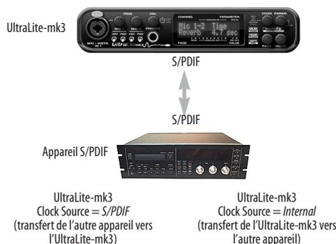
Figure 4-6 : La configuration pour synchroniser un appareil S/PDIF à l'UltraLite-mk3. La synchronisation s'effectue par l'intermédiaire de la liaison d'entrée/sortie numérique elle-même. Si vous enregistrez depuis l'autre appareil, il faut choisir "S/PDIF" comme source d'horloge pour l'UltraLite-mk3.
